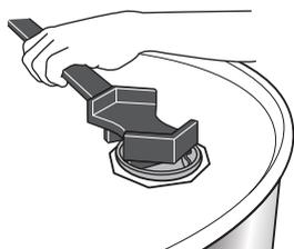
使用するドラム缶のフタ形状に合った差込口を差し込んで開閉します。差込口は様々なサイズと形状で使うことができるよう設計してあるので、ドラム缶の各種フタに対応します。
