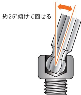
六角棒レンチを約25°傾けたまま回せるので、障害物を避けながら作業ができます。
