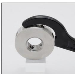
・スパナのピン径より穴径が大きなナットで使用して下さい。穴径が小さいナットで使用するとスパナがナットに接せず、ピンが折れる危険性があります。
