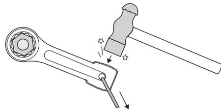
スパナの柄穴にロープを通し、締付け方向に引っ張りながら叩部をハンマーで叩いて使用します。
