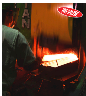
熟練工による熱間鍛造
